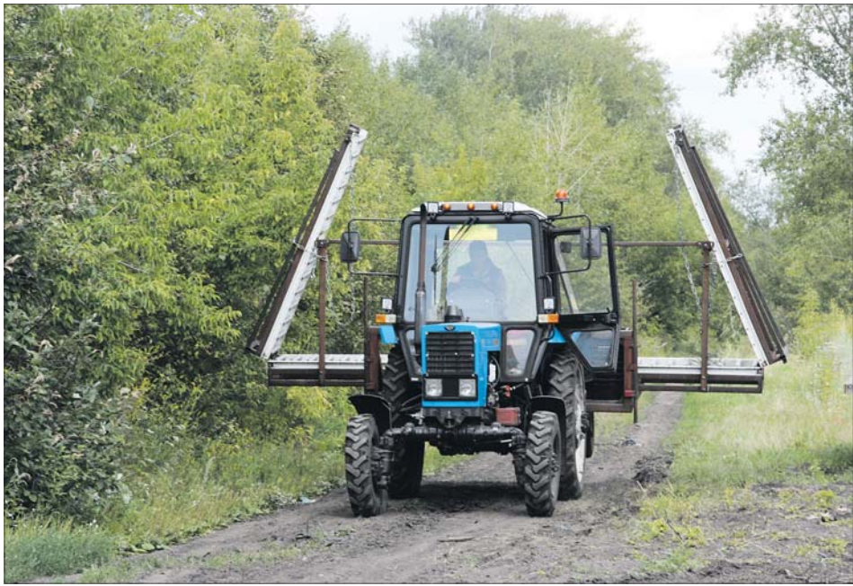
Навесное приспособление к трактору, которое сконструировал руководитель плодопитомника Михаил Михайловский, механизмирует процесс сбора кабачка, минимизирует трудовые и временные затраты.
